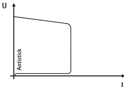
Устройство Antistick предотвращает прокаливание электрода.
